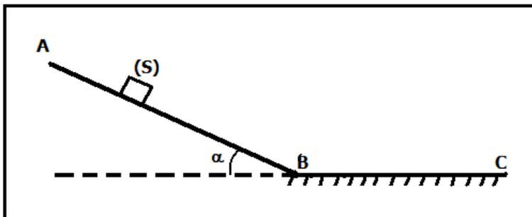
جزء AB طوله  $AB = \ell = 1,2\text{m}$  مائل بزاوية  $\alpha = 30^\circ$  بالنسبة للمستوى الأفقي حيث التماس يتم بدون احتكاك .
