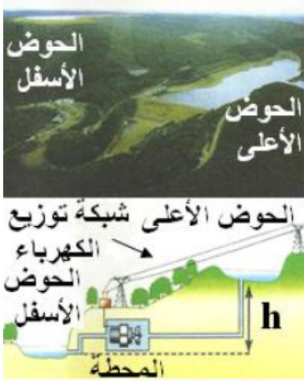
تشتغل المحطة الكهرومائية لتوليد الكهرباء بالاعتماد على جريان الماء من الحوض الأعلى نحو الحوض الأسفل مما يؤدي إلى تشغيل تربينات المحطة فتنتج تيارا كهربائيا ينقل عبر شبكة التوزيع إلى المستهلكين .
