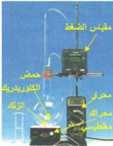
قبل التفاعل ، يوجد الهواء داخل الحوالة أي  $P_i = P(\text{الهواء})$  . ويؤدي التفاعل بين الزنك وحمض الكلوريدريك إلى تكون غاز ثنائي الهيدروجين فيصبح الضغط داخل الحوالة هو  $P = P(H_2) + P(\text{الهواء})$ .
