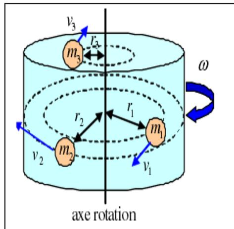
$$\text{Energie cinétique du solide} = \frac{1}{2} m_1 v_1^2 + \frac{1}{2} m_2 v_2^2 + \frac{1}{2} m_3 v_3^2 + \dots$$
