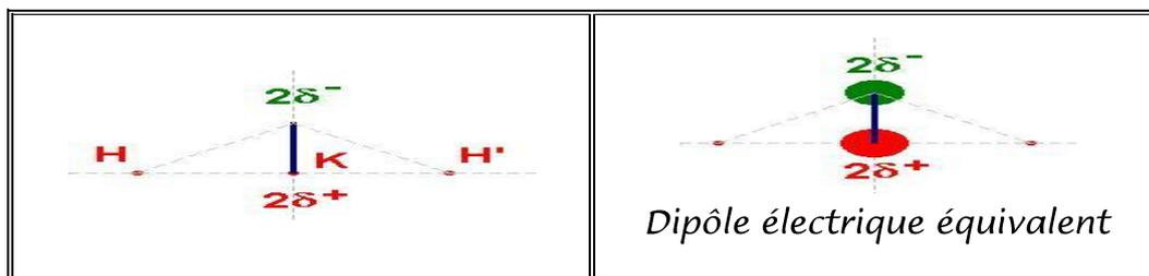
Du point de vue de la répartition des charges, les deux charges partielles  $\delta^+$  sont équivalentes à une charge unique  $2\delta^+$  située au point K situé au milieu du segment HH'. C'est le **barycentre** des charges positives. (Le barycentre de 2 charges électriques  $q_1$  et  $q_2$  est un point de l'espace où une charge  $q = q_1 + q_2$  aurait le même effet que les deux charges  $q_1$  et  $q_2$  qu'elle remplace.)
