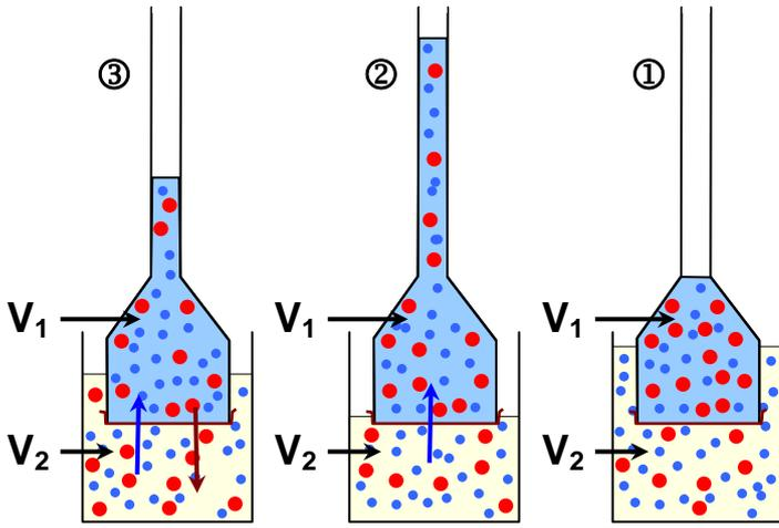
نستعمل مقياس التنافذ كما هو مبين في الأشكال أمامه. في بداية التجربة ① يحتوي الوسط  $V_1$  على ماء مقطر والوسط  $V_2$  على محلول السكر. يفصل بينهما غشاء نفوذ لجزيئات الماء والمادة المذابة. ونتتبع حالة التجربة بعد بضع دقائق (الحالة ②) وبعد بضع ساعات (الحالة ③).
