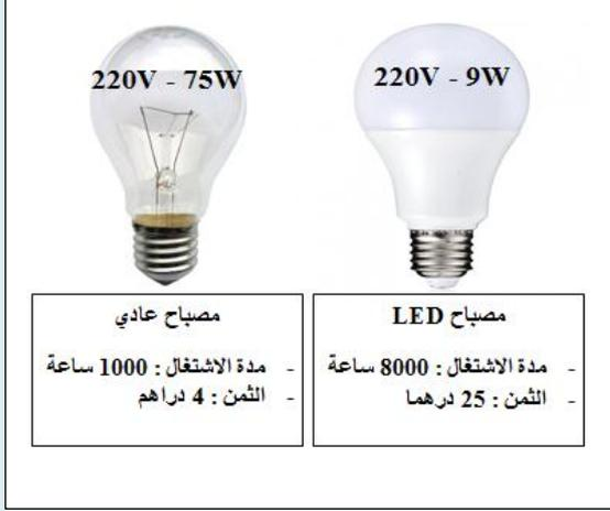
نحسب الطاقة الكهربائية المستهلكة بـ (KWh) من طرف كل مصباح خلال المدة الزمنية  $t = 8000h$  :
