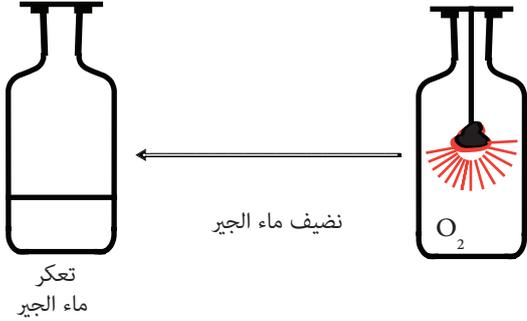
**تجربة :** نسخن قطعة من الفحم (الكربون C) بواسطة موقد بنسن حتى تتوهج ثم ندخلها في قارورة مملوءة بالهواء، ثم بعد ذلك في قارورة مملوءة بثنائي الأوكسجين  $O_2$ .
