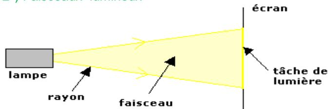
Un faisceau de lumière est un ensemble de rayons provenant d'une même source. Les bords d'un faisceau sont représentés par ses rayons limites.
