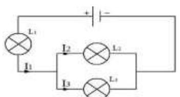
7- soit le montage électrique suivant , sachant que la tension électrique aux bornes de la pile **U<sub>P</sub>= 12V**, et la tension électrique aux bornes de la lampe **U<sub>L</sub>= 2.5V**.
