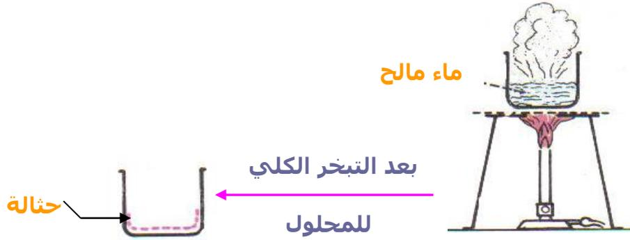
**استنتاج :** بعد التبخر الكلي للمحلول، نلاحظ توضع أجسام صلبة على الجوانب الداخلية لأنبوب الاختبار ، تسمى هذه الأجسام **الحبات Résidu** .
