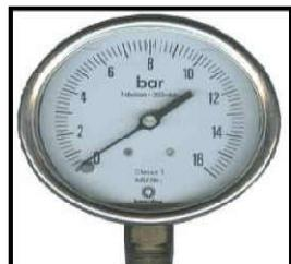
لقياس ضغط غاز محجوز نستعمل جهاز المانومتر ( Manomètre ) .
