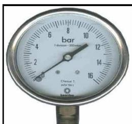
لقياس ضغط غاز محجوز نستعمل جهاز المانومتر ( Manomètre )
