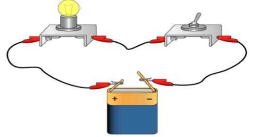
**ملحوظة :** يمر التيار الكهربائي في كل عناصر الدارة الكهربائية عندما يكون قاطع التيار مغلقا
