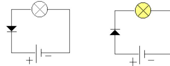
الصمام الثنائي عبارة عن ثنائي قطب وظيفته السماح بمرور التيار الكهربائي الموافق لمنحى السهم المحدد عليه.
