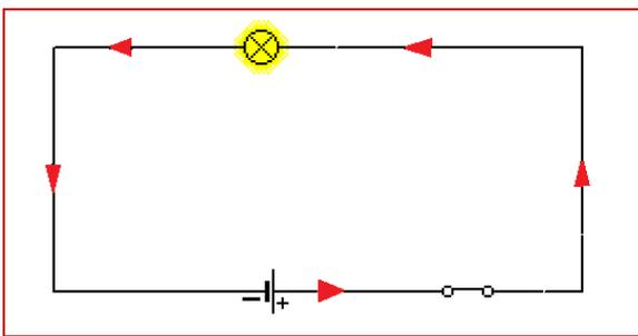
نستنتج أن للتيار الكهربائي المستمر منحنى ، و قد اصطلح على أن التيار الكهربائي المستمر يمر خارج العمود في الدارة الكهربائية من القطب الموجب ( + ) إلى القطب السالب ( - ) ، نمثله بسهم كما هو مبين في التبيانة .
