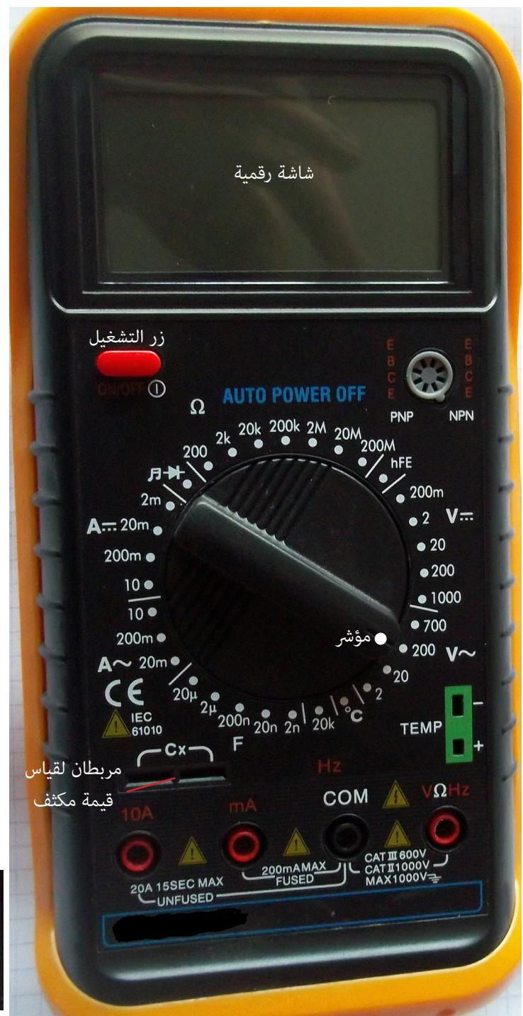
جهاز متعدد القياسات Multimètre يمكن أن يلعب دور الأمبيرمتر أو الفولومتر وأدوات أخرى
