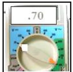
**2. Donner la valeur de la résistance mesurée par le multimètre qui affiche 0,70 sur son écran sachant que le calibre utilisé est 20MΩ. R= .....**
