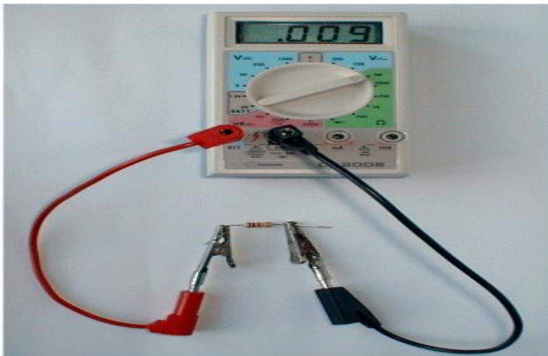
La résistance à mesurer est simplement branchée entre la borne COM et la borne repérée par la lettre  $\Omega$ .
