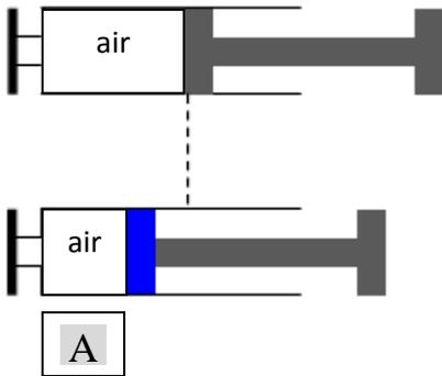
On ferme l'orifice de la seringue et on tire le piston
