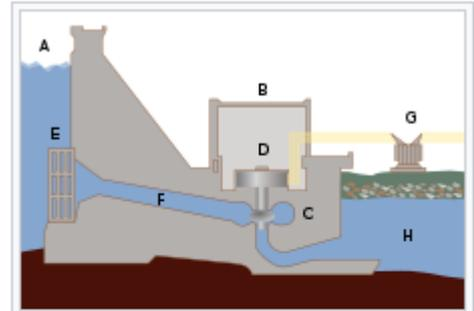
Schéma en coupe d'un barrage hydroélectrique.
